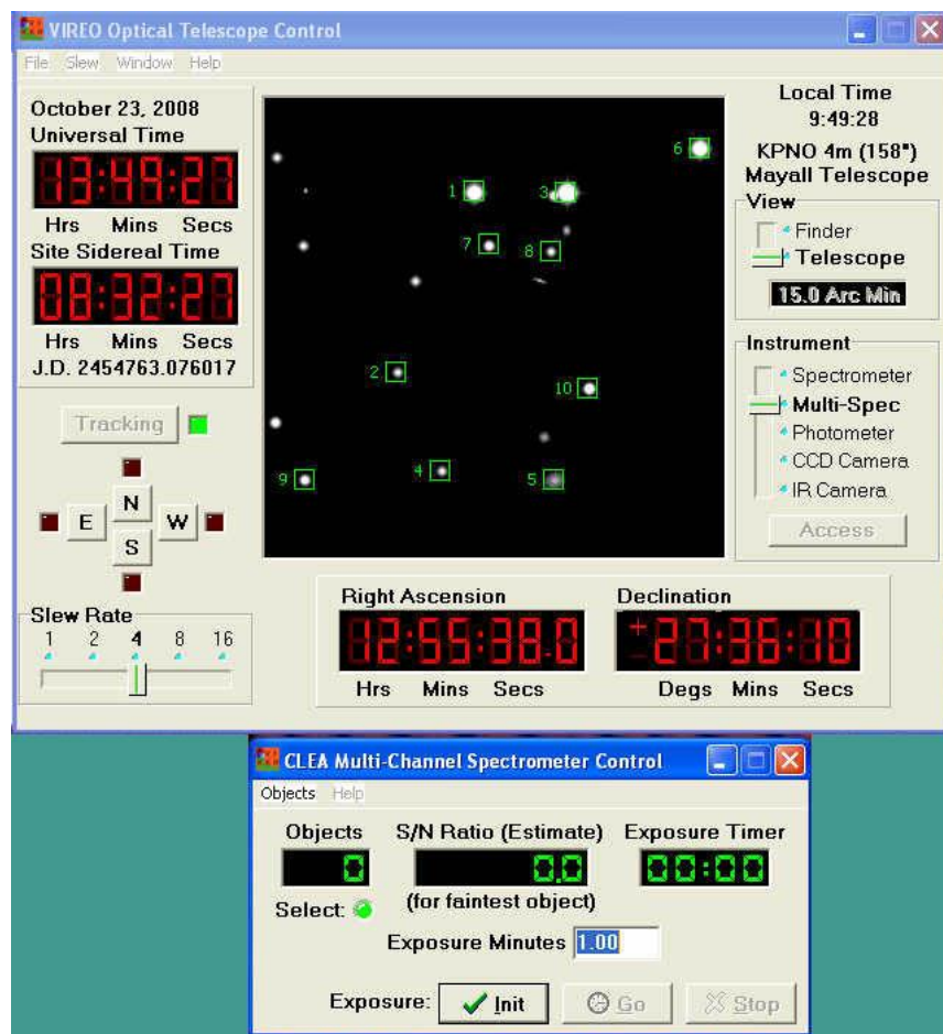
Figura 5: El Panel de control del espectrógrafo multicanal (abajo) y la ventana de imagen de VIREO mostrando los objetos seleccionados (arriba)
